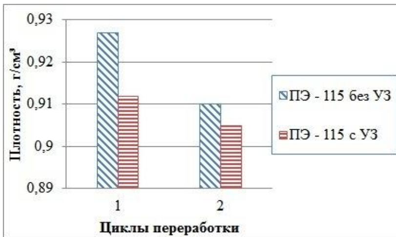
Рисунок 3.8 – Зависимость плотности ПЭ-115 от количества циклов переработки
