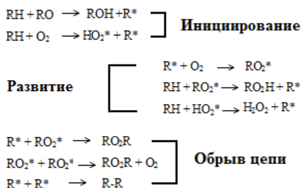
Рисунок 1. Общая схема элементарных реакций окисления полимеров
