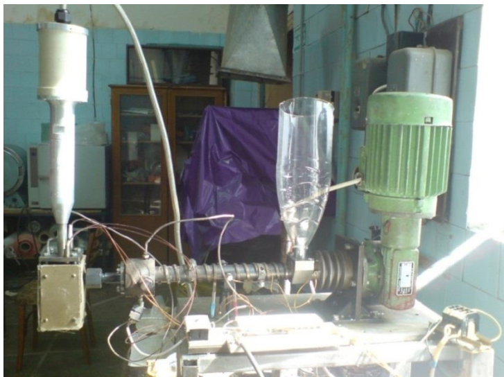
Рисунок 2.1 – Внешний вид лабораторной экструзионной установки, работающей совместно с ультразвуковой виброприставкой.
